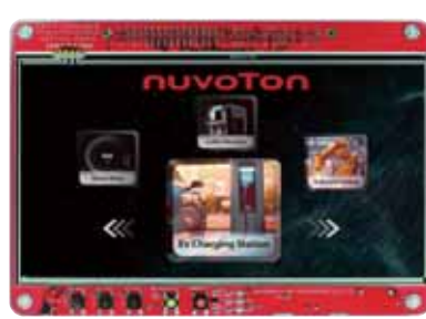
MA35H0 EVB & Demos NuMaker-HMI-MA35H0-A1
