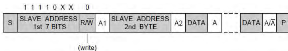
图 18-15 10bit 寻址，主机向从机写入数据
