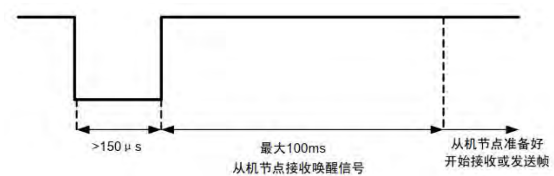
图 21-15 LIN 总线唤醒信号
