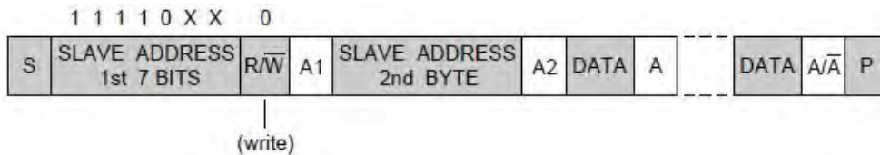
图 19-14 10bit 寻址，主机向从机写入数据
